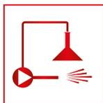
**Hochdruck-Chemie mit Regelventil**: Die Pumpe saugt (bei geöffnetem Reinigungsmittelventil) neben dem Wasser gleichzeitig Reinigungsmittel an, welches somit mit Hochdruck aufgetragen werden kann.
