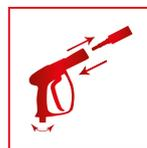
Das **QC315 Schnellkupplungssystem** ermöglicht einen raschen Wechsel von verschiedenen Lanzen, Düsen und weiterem Zubehör – ohne weiteres Werkzeug zu gebrauchen. Mit Anti-Twist-System und Edelstahl.
