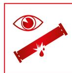
**Leckage-Erkennung**: Im Falle einer Leitungs-Leckage innerhalb des Hochdruckreinigers, des Schlauches oder der Schalt pistole stellt sich der Hochdruckreiniger selbständig ab.
